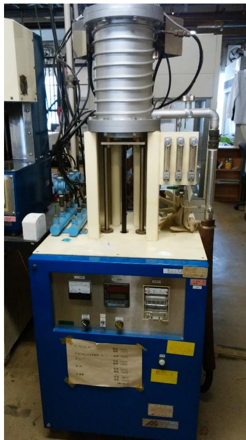
雰囲気制御 高温焼成炉 1600°C
