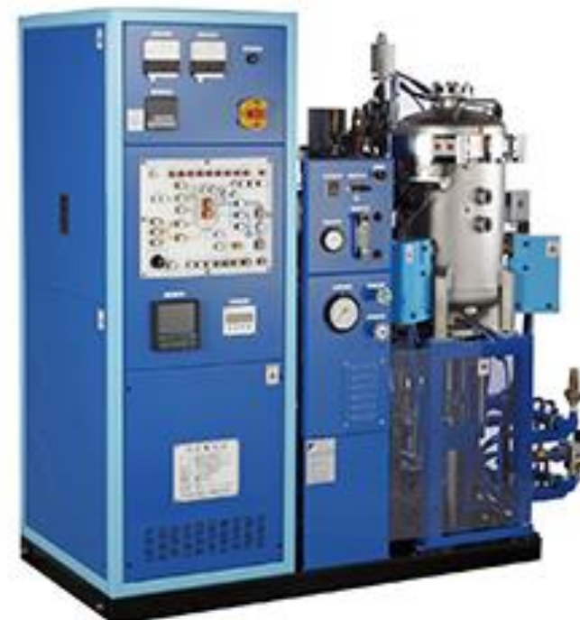
加圧高温焼成炉 2000°C 2024.5撤去
