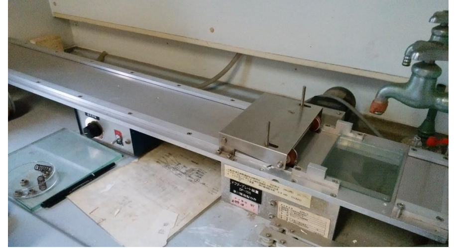
ドクターブレード 薄膜成形 厚さ 50 \mu m
