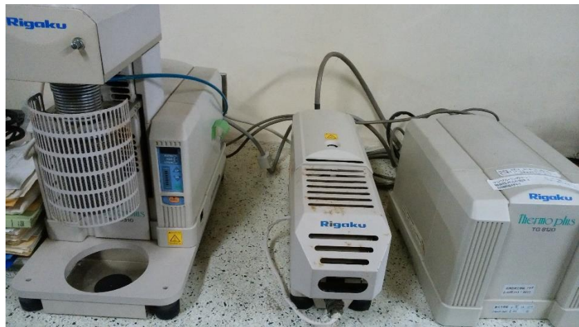
熱重量分析(示差熱天秤) 熱膨張計 ~1300°C
